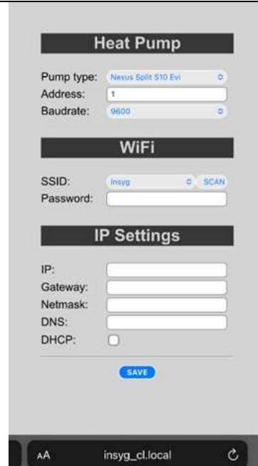
8. Im INSYG CLOUD-Steuergerät im Feld Pumpentyp das entsprechende **Pumpenmodell** einstellen:
